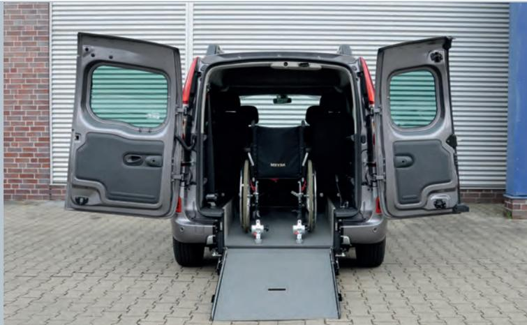
Rollstuhl sicher im Fahrzeug durch Retraktoren und Gurte fixiert.
