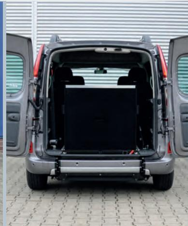
Abfahrbereites Fahrzeug mit eingeklappter Rampe.
